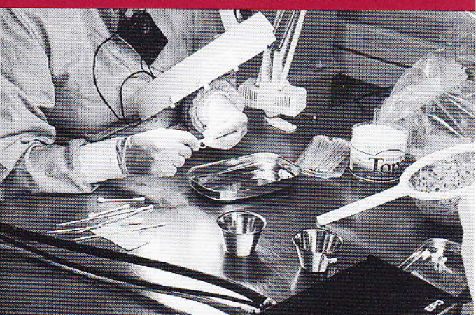
Varje ventil tillverkas för hand under kirurgisk noggrannhet i helt dammfria lokaler.
